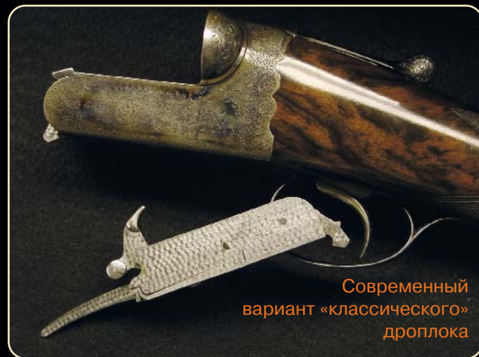
Модификация дропlocka 1907 г.: замки вынимаются без всяких усилий
