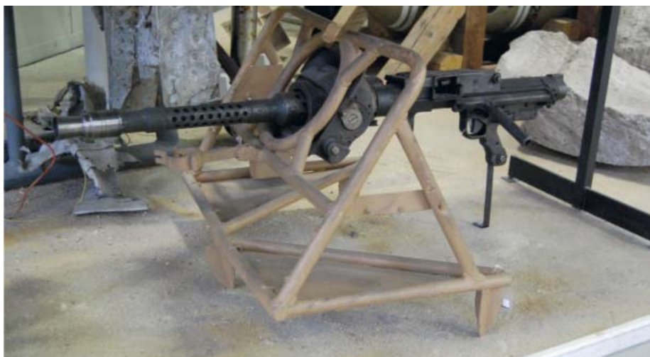
Импровизированный наземный лафет с пулемётом MG 131 – одна из попыток восполнить нехватку пехотных пулемётов за счёт снятых с самолётов люфтваффе авиационных пулемётов. Военно-исторический музей бундесвера в Дрездене. Фото автора
